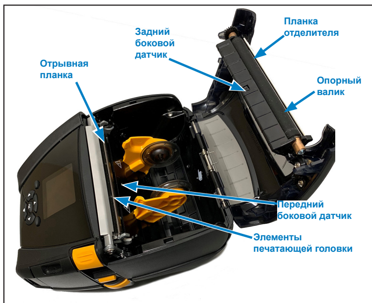
Рис. 33 • Очистка принтера ZQ630 (носитель с подложкой)
